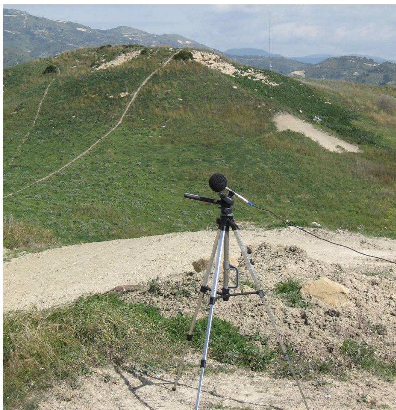
Figura 3. Postazione di misura con microfono su treppiede e prolunga per l'acquisitore dati
